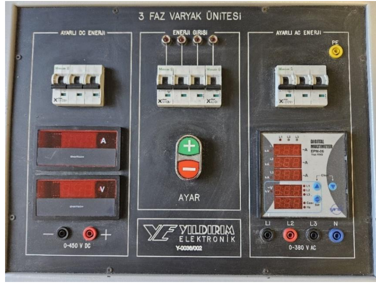
EK 1. 3 Faz Varyak Ünitesi
