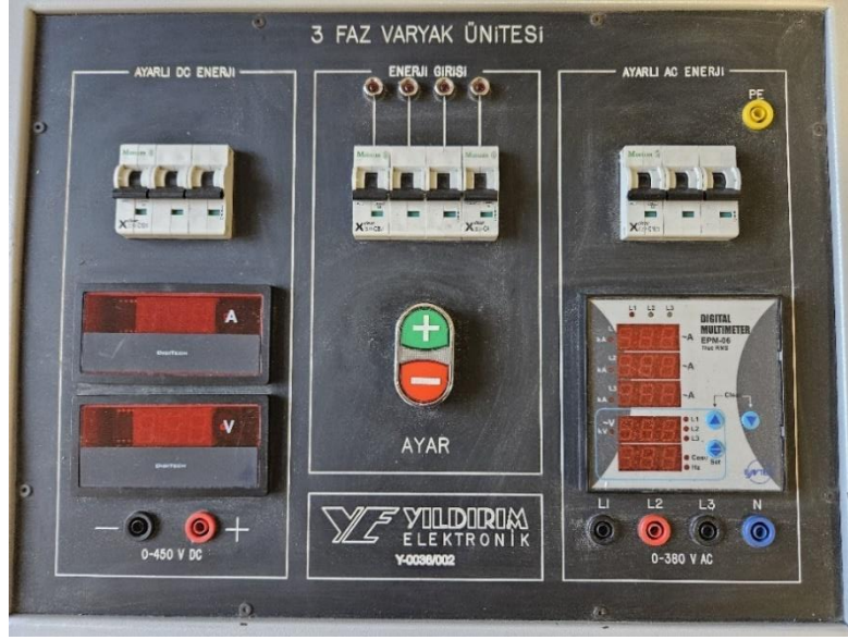
EK 1. 3 Faz Varyak Ünitesi
